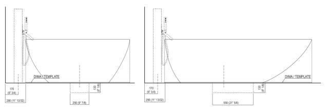
Per un corretto posizionamento del pozzetto e della rubinetteria è necessario utilizzare la dima in cartone con
