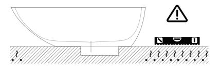
La vasca deve essere installata su un pavimento perfettamente piano. The bathtub must be positioned on a flat floor surface.
